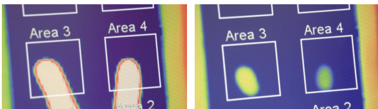
Die Wirksamkeit des wärmeleitenden Füllstoffs SILATHERM® ist offensichtlich: Schon kurz nachdem die Bereiche 3 und 4 gleichzeitig mit den Fingerspitzen einer Hand berührt wurden, zeigt das Areal 4, das SILATHERM® enthält, dank der verbesserten Wärmeabfuhr eine deutlich geringere Restwärme.
